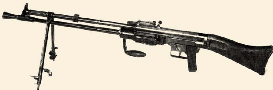
7,92-мм ручной пулемёт MG.35/36 «Кнорр-Бремзе» на сошке. Вид слева. Обратите внимание на устройство газовой камеры, флажок (рычажок) предохранителя над пистолетной рукояткой, а также на закрытую крышку гнезда магазина
