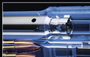
Прямое запирание в стволе посредством 6 боевых упоров
